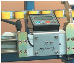
Guida Drylin®W in un sistema di paracolpi nell'industria del vetro
